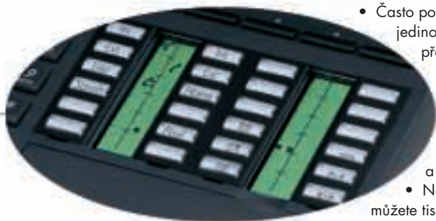
6 naprogramovaných kláves, 18 programovatelných kláves, 24 grafických symbolů (6 režimů - například klepání hovoru, podržení hovoru, volání a další)
